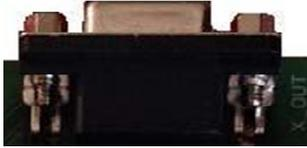
Connexion vers d'autres extensions FD0003. Possibilité de connecter 3 cartes extension pour obtenir 128 entrées / sorties suivant la configuration du système de cartes.
