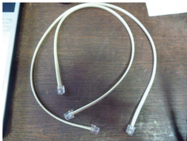
1 câble bus 1 câble d'alimentation 5V
