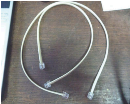
1 câble bus / 1 câble d'alimentation 5V
